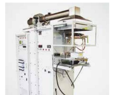
Cone Calorimeter zur Untersuchung des Brandverhaltens
