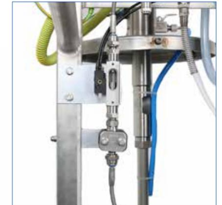
Optional mit Peroxid-Durchflussüberwachung
