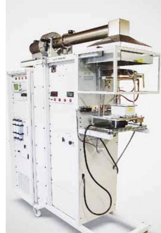
Cone Calorimeter – zur Untersuchung des Brandverhaltens
