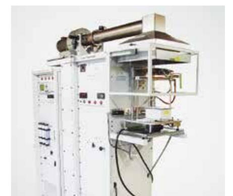
Cone Calorimeter zur Untersuchung des Brandverhaltens
